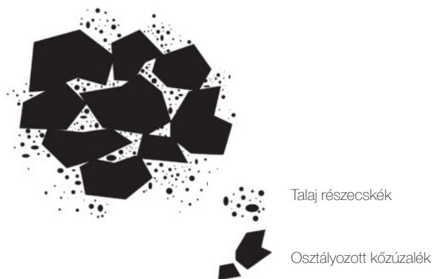
32. ábra: A mesterséges vázталaj (structural soil) sematikus ábrája
