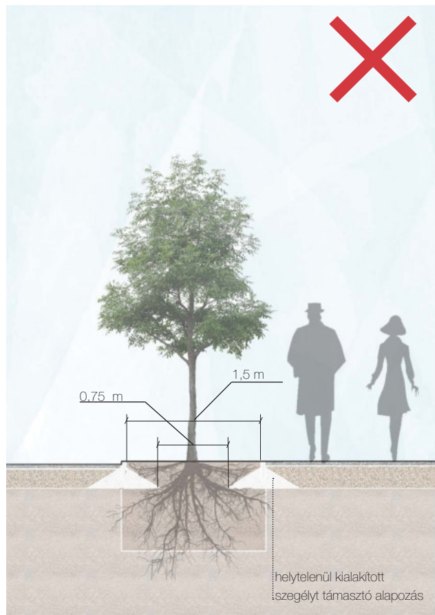
Burkolatban lévő fahely helytelen kialakítása
