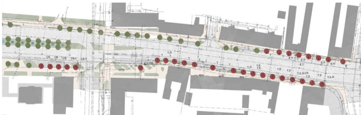
49. ábra: Tervezett fák közműérintettsége az Árpád út bevezető szakaszán
