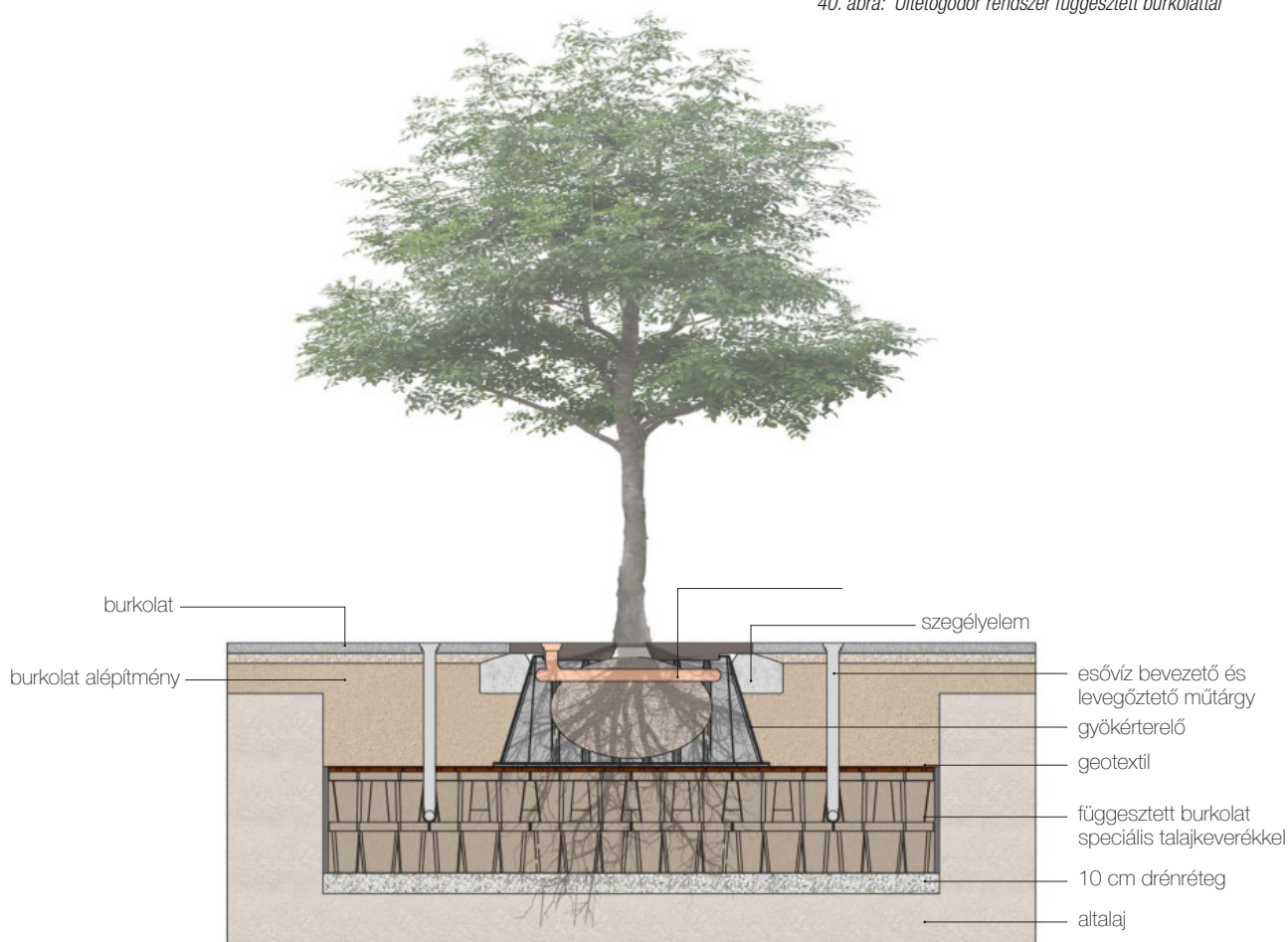
40. ábra: Ültetőgödör rendszer függesztett burkolattal
