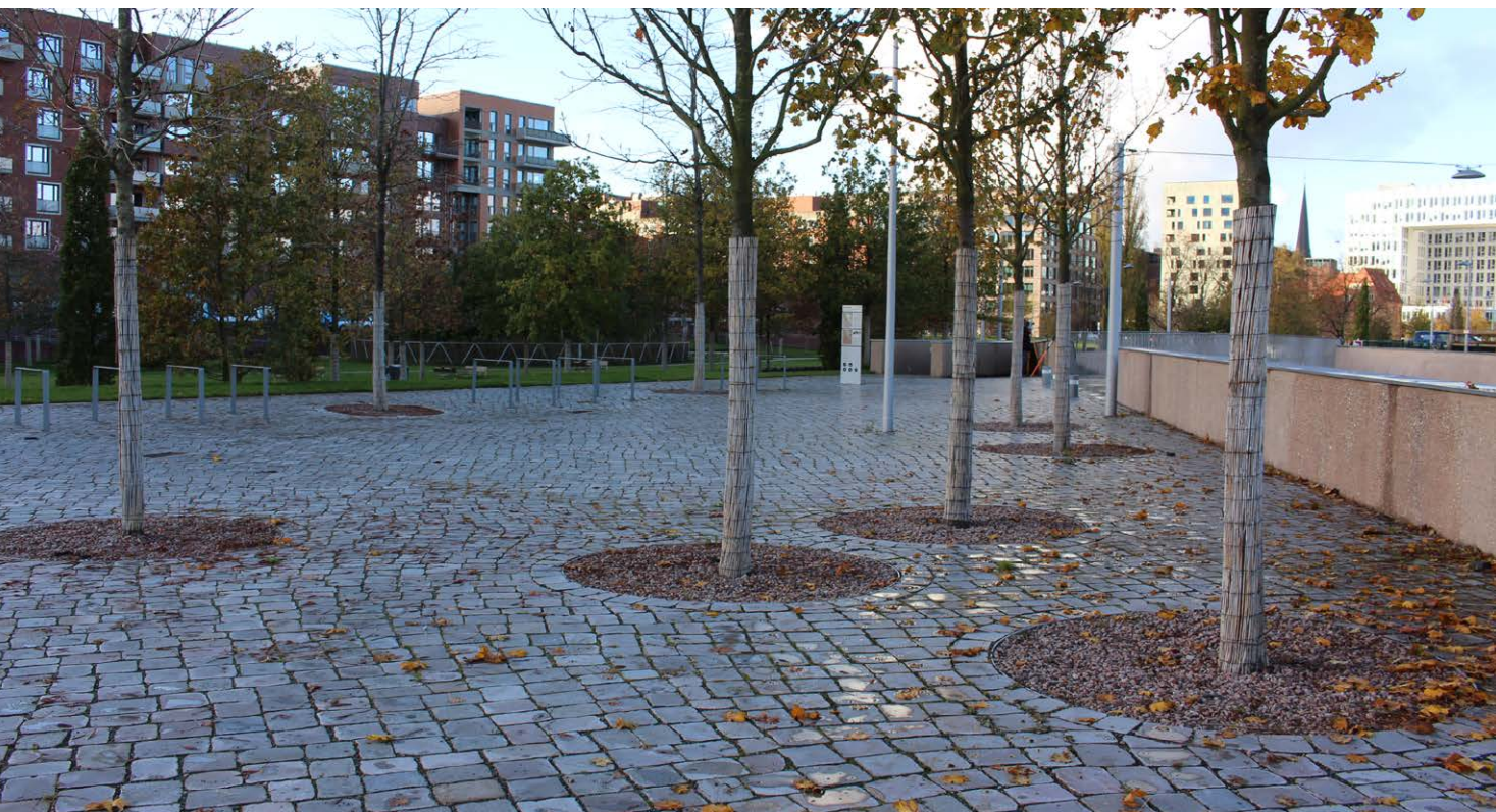
18. fotó: A kiselemes terméskő burkolat átteresztí a vizet a fák gyökeréhez, Lohsepark, Hamburg
